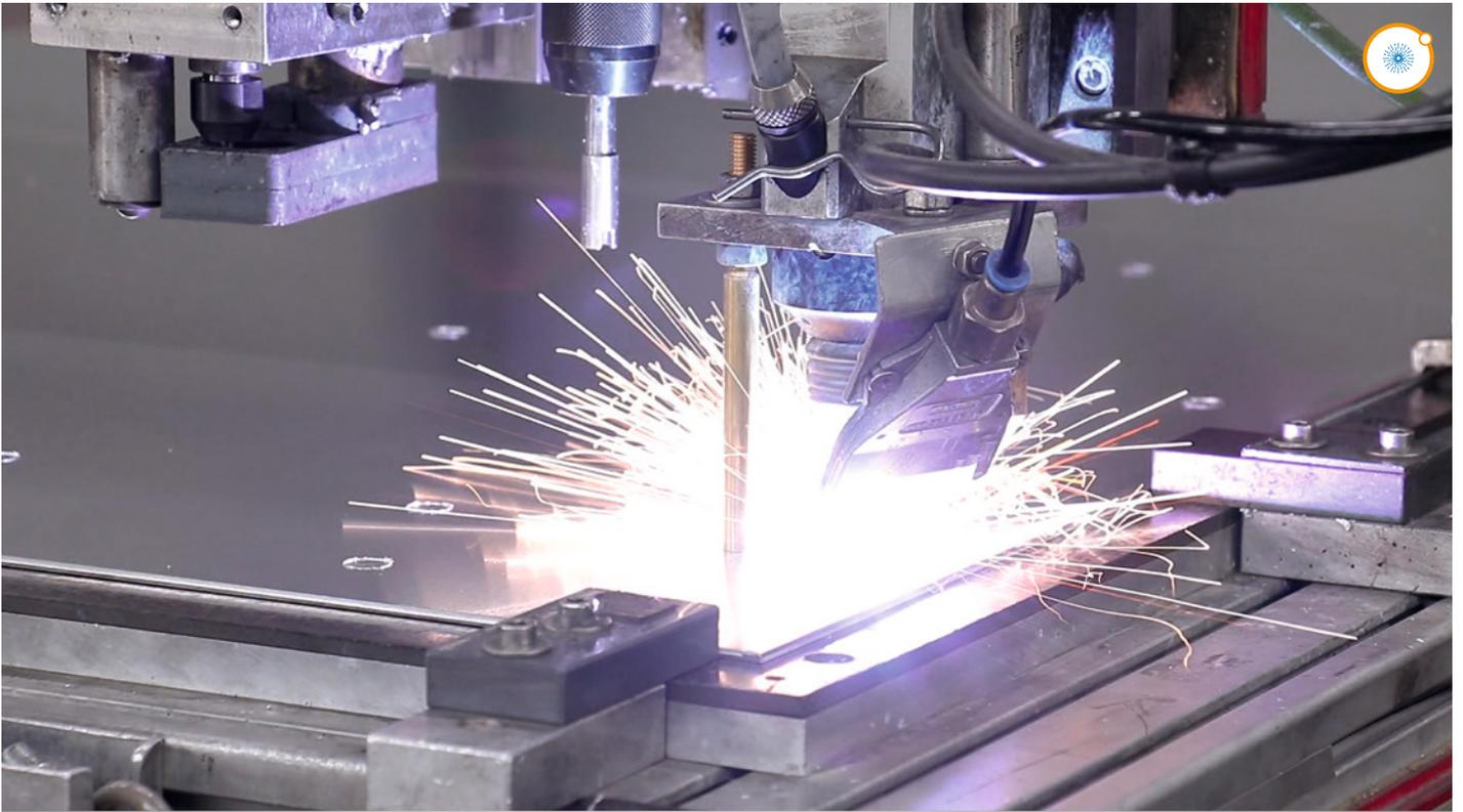
Zertifiziertes Peko-Bolzenschweißen auf CNC-Schweißanlage
